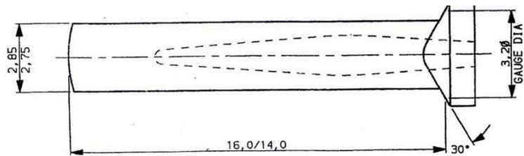
Для свечей зажигания с долгим сроком службы мы производим электрод с медным сердечником с платиновым компонентом. Наличие платины в электродах позволяет производителям свечей зажигания предлагать на рынке долговечную продукцию. На чертеже можно наблюдать несколько типов платиновых электродов. Мы можем изготовить и другие типы в соответствии с запросом заказчика.
